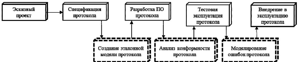
Рисунок 2 – Модифицированная структура жизненного цикла сетевого протокола
