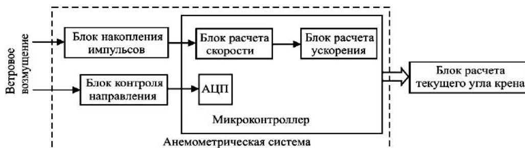
Рисунок 2 – Функциональная схема анемометрической системы
